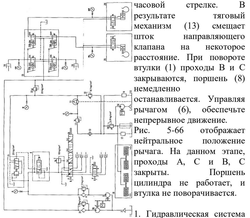
коробки передач и рулевого управления
