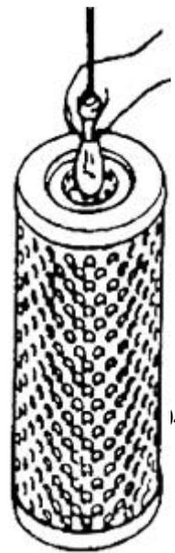
Для удаления маслянистых пятен поместить фильтр в теплую воду с очищающим средством, затем промыть его чистой водой, просушить и проверить.
